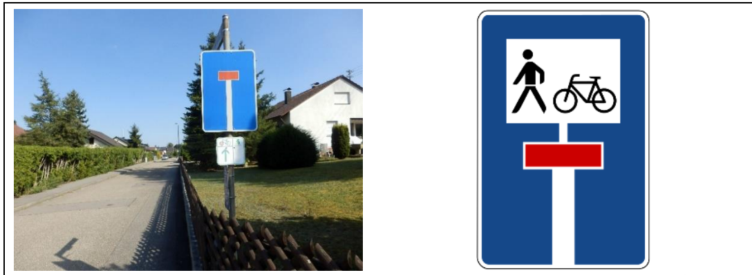
Abbildung 12: Fehlerhafte Sackgassenbeschilderung in Lienzingen (links) und korrektes Verkehrszeichen 357-50 StVO (rechts) (Fotos: R+T)
